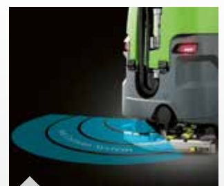
Kollisionsschutzsystem warnt bei Rückwärtsfahrt vor Hindernissen
