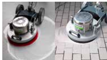
▶ Grundreinigung mit Wasser von Hart- und Vinylböden
